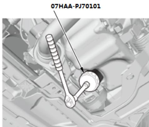
1. 手工安装机油滤清器。
