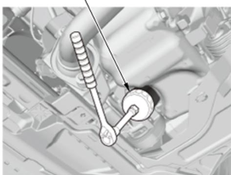
1. 用机油滤清器扳手，拆下机油滤清器。
